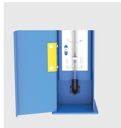
3. De ser necesario, desplazar la regla para ubicar el cero con el nivel del líquido.
