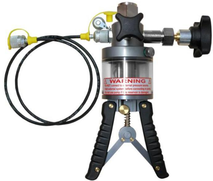
El instrumento de referencia se conecta directamente en la parte superior de la bomba y la unidad bajo prueba se conecta por medio de una manguera de conexión con un adaptador de 1/4" H BSP. (Adaptadores NPT y métricas están disponibles como accesorios.)
