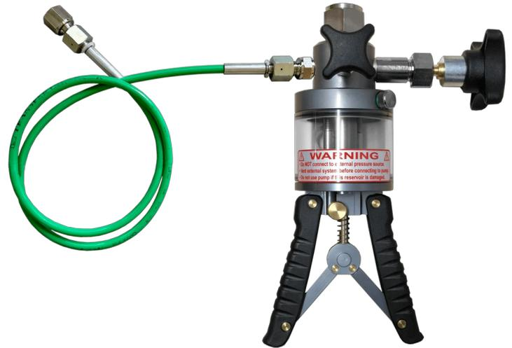
El instrumento de referencia se conecta directamente en la parte superior de la bomba y la unidad bajo prueba se conecta por medio de una manguera de conexión con un adaptador de 1/4" H BSP. (Adaptadores NPT y métricas están disponibles como accesorios.)
